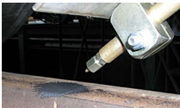
Dysza spryskująca do aplikacji smaru na główkę szyny.
